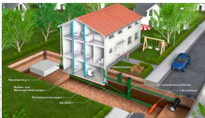
Anwendungsbeispiel für Kunststoffrohrsystem KG2000 aus PP-MD zur Abwasserentsorgung
