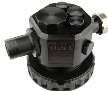
Bild 4: Multiflex Block mit ClampCon-Verbindung als Anschlussadapter für IBC-Container, elektrisch leitfähige Ausführung in PE-el, Hersteller Kwerk GmbH (© Kwerk GmbH, Montabaur)
